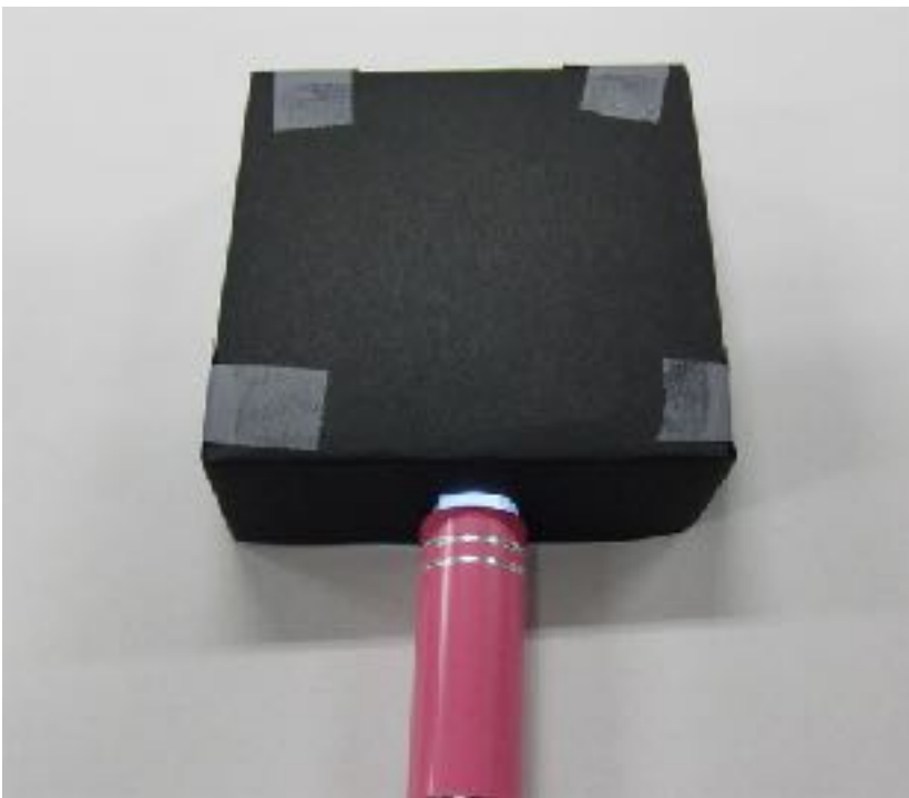
図.3-3 暗箱を被せたシャープにスリットからLEDライトを当てている状態。この状態で10分間待機する。
